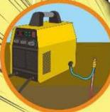
電氣設備非帶電金屬部分應行接地。
